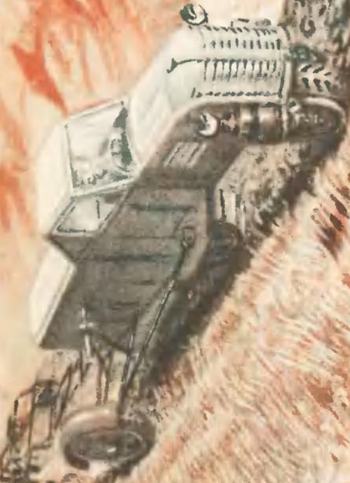
Сталибадские школьники построили модель трактора, которая может двигаться по склонам крутизной до 65°. Здесь дана принципиальная схема выравнивающего механизма. При наклоне трактора маятник включает ток в электромотор, и винт, вращаясь, возвращает трактор в вертикальное положение.
